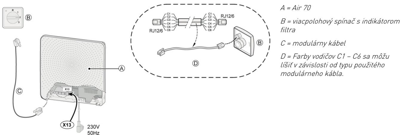
Pri použití modulárneho kábla musí byť „jazýček“ oboch modulárnych konektorov namontovaný tak, aby smeroval k značke na modulárnom kábli.
